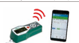
se connecte aux téléphones portables par bluetooth (uniquement avec système Android), affiche les valeurs de rugosité, le profil et la courbe
