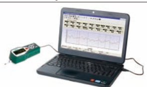
se connecte aux ordinateurs par le biais d'un câble USB (logiciel inclus), affiche les valeurs de rugosité, le profil et la courbe
