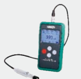
VÉRIFICATION D'ÉPAISSEUR DES REVÊTEMENTS
