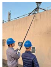
inspection de la construction (transmission d'images en temps réel par WIFI)
