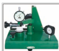
vérifier la répétabilité des indicateurs à cadran
