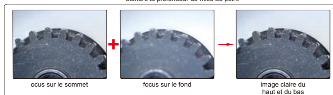
étendre la profondeur de mise au point
