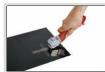
étape 1 : création d'une grilledécoupe sur la surface
